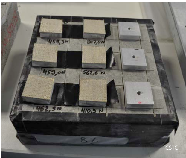
2 | Essai d'adhérence sur chape.
