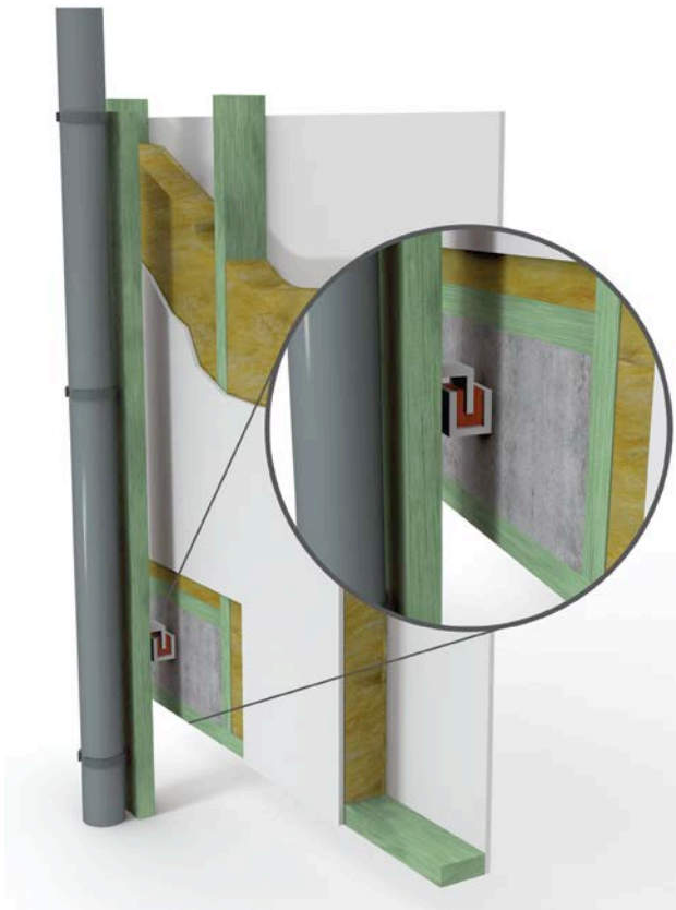
2 | Dispositif antivibratoire élastique placé entre un tuyau d'évacuation sanitaire et un mur à ossature bois doté d'un lestage local en béton.
