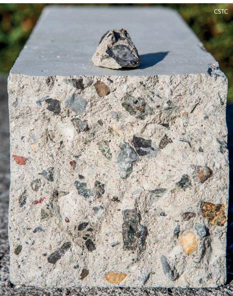
1 | Granulats de béton recyclés.
