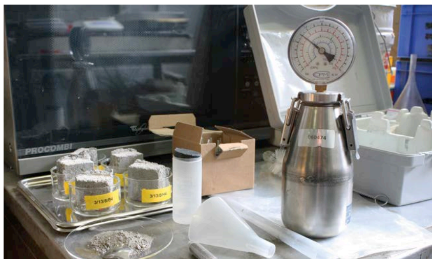
1 | Exemple de bombe à carbure utilisée pour mesurer la teneur en eau.
