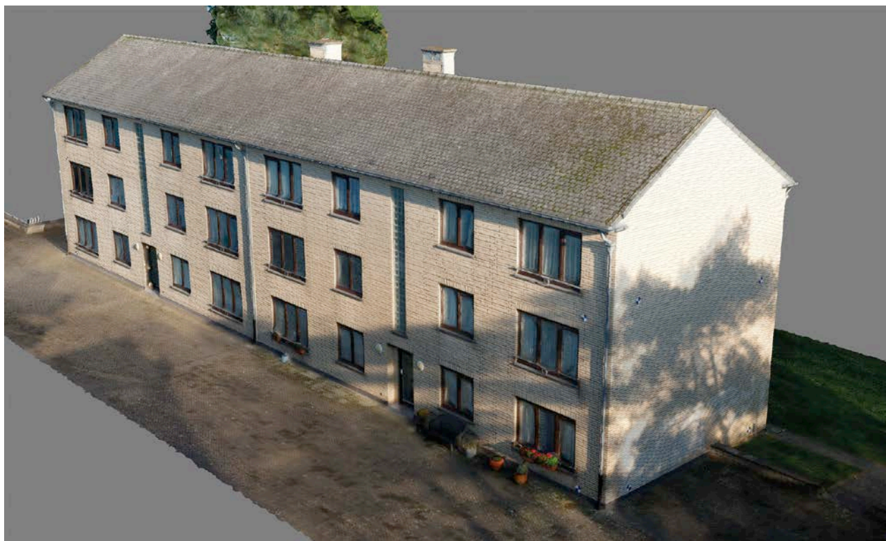
Modèle 3D réalisé à l'aide d'un logiciel spécifique et d'un grand nombre de photos.
