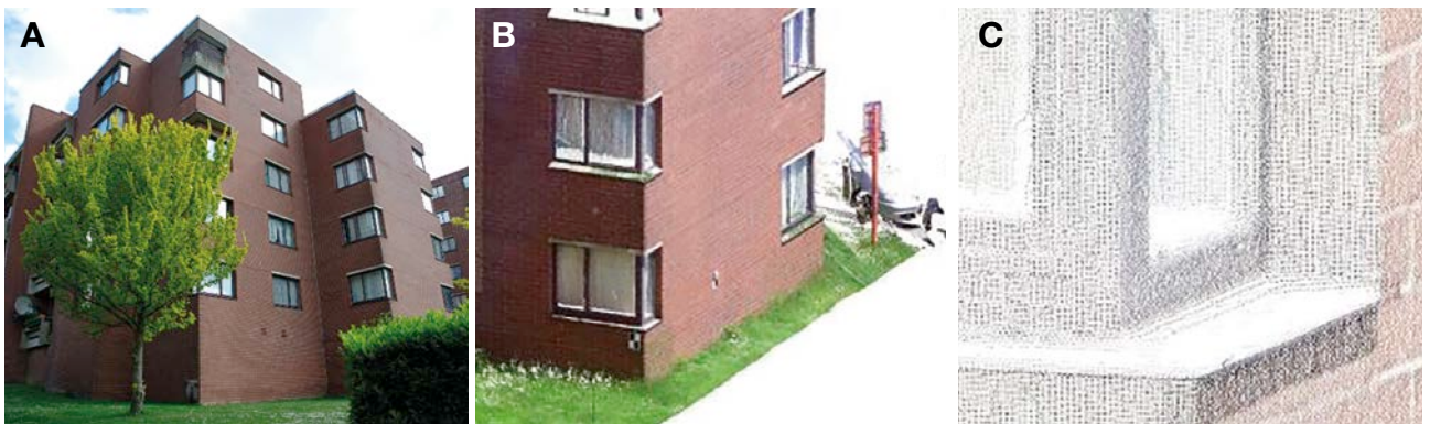
1 | A. Bâtiment que l'on désire numériser en 3D. B. Modèle 3D du bâtiment généré par un relevé au scanner laser. C. Zoom sur le modèle révélant les milliers de points qui le constituent.
