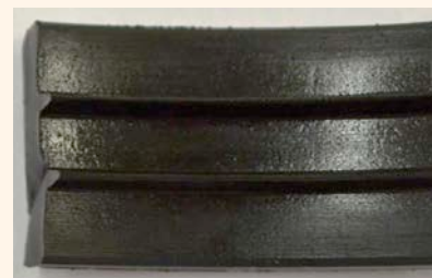
3 | EPDM enduit de silicone (après essai)
