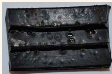
2 | EPDM enduit de graisse (après essai)
