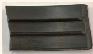
5 | EPDM enduit de détergent (après essai)
