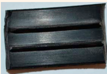
1 | EPDM (avant essai)
