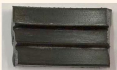
4 | EPDM enduit de savon noir (après essai)
