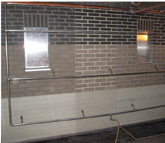
1 | Maquette d'essai pour ETICS avec revêtement dur
