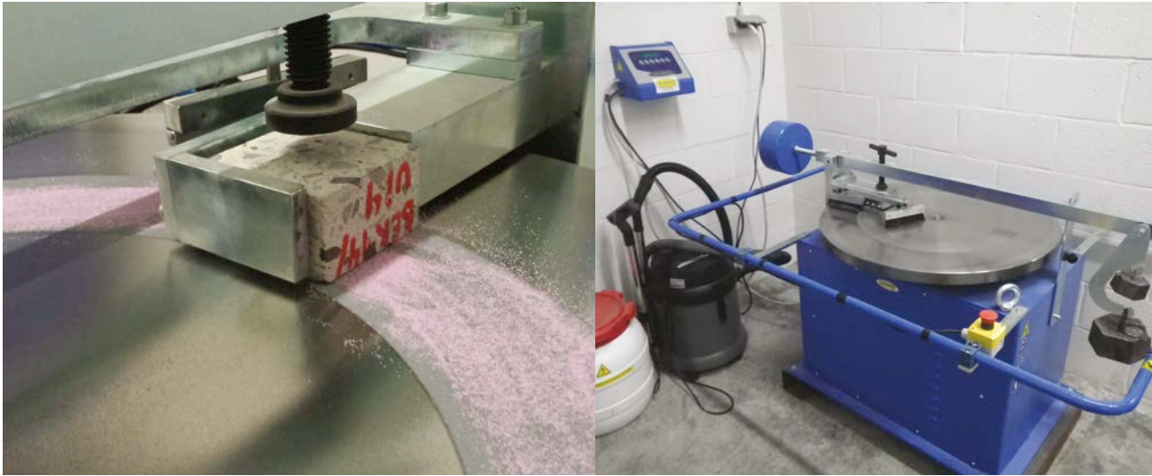
Dispositifs d'essai permettant de déterminer la résistance à l'usure des sols en béton d'après Böhme
