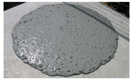
4 | L'extrême fluidité du béton autocompactant engendre, sur les parois du coffrage, des poussées nettement supérieures à celles générées par un béton vibré traditionnel.
