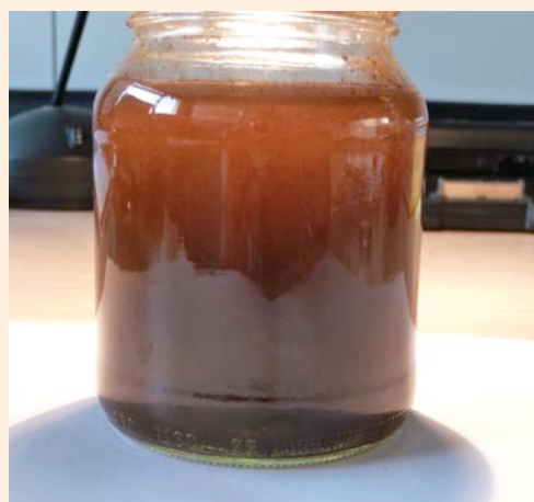
Présence d'hématite ou rouille en suspension dans l'eau
