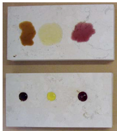
Application des agents tachants (café, huile, vin) sur une dalle non traitée (en haut) et sur une dalle traitée (en bas)
