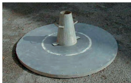
Fig.1 Mesure de l'étalement au cône d'Abrams ( slump-flow ).
