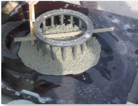
Fig.5 Essai à l'anneau (J-ring).
