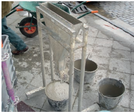
Fig.2 Essai d'écoulement à l'entonnoir en V.
