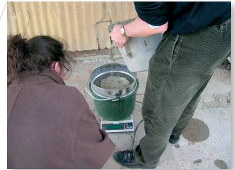
Fig.4 Essai de stabilité au tamis.
