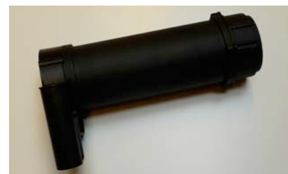
14 | Dispositif innovant permettant de stabiliser le flux avec la méthode de l'anémomètre à grande hélice.
