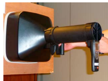
15 | Méthode combinant l'anémomètre à hélice à un dispositif stabilisateur du flux.
