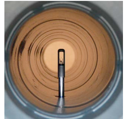
11 | Utilisation d'une petite sonde dans un conduit circulaire.
