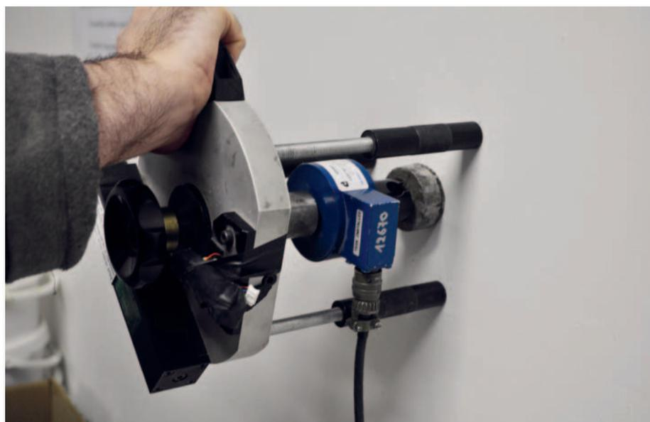
Fig. 4 Essai d'arrachement selon la norme NBN EN 1504-2
