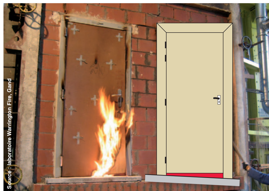
Fig. 1 Défaut d'horizontalité et/ou de planéité du sol au droit de la porte résistant au feu en position fermée et passage de l'incendie
