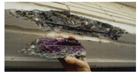
Fig. 1 Profondeur de carbonatation sur une surface de rupture fraîche.
