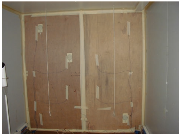
Fig. 20 Vue du composant unique testé, prise de l'intérieur de la cellule PASLINK.
