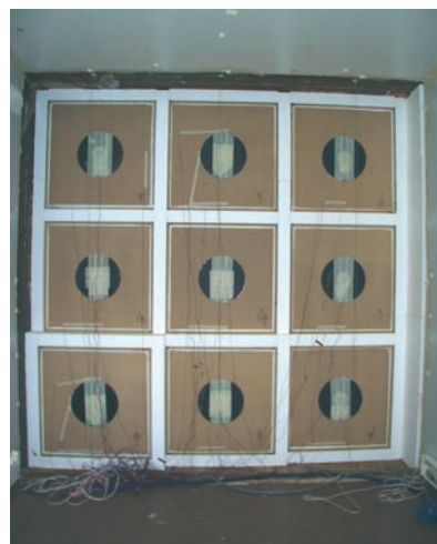
Fig. 12 Vue des neuf composants, prise de l'intérieur de la cellule PAS-LINK.
