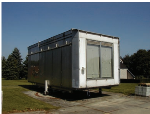
Fig. 9 Cellule d'essai extérieure PASLINK (essai sur un composant translucide).
