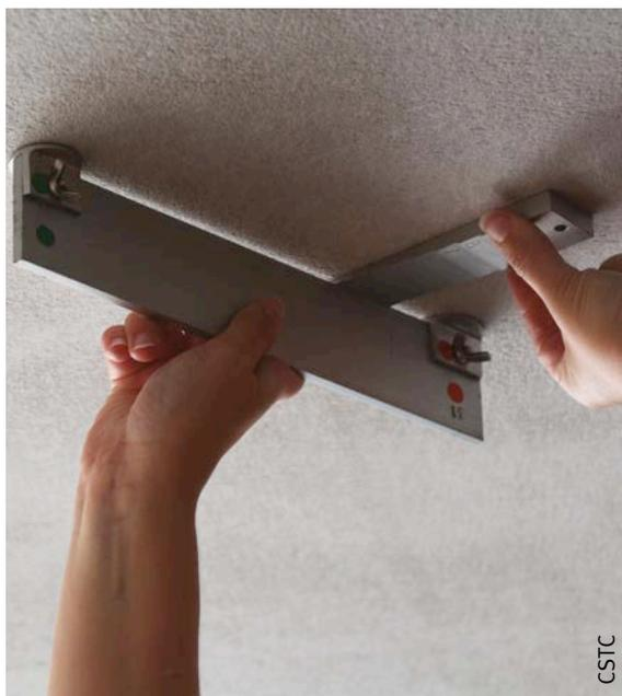
Fig. 2 Contrôle des tolérances de planéité sous la règle de 20 cm.
