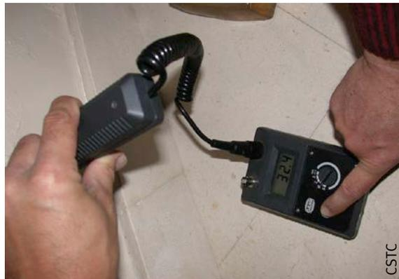
Fig. 6 Humidimètre électrique.
