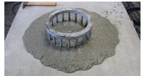
Détermination de la consistance du béton à l'aide du J-Ring.
