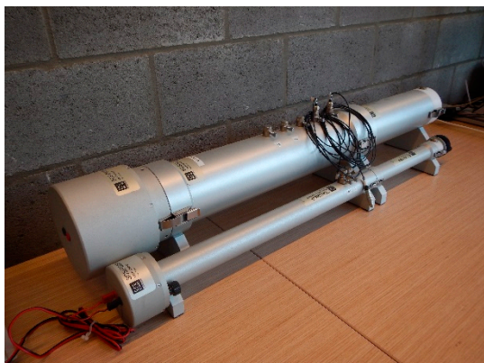
Figure 1 Détermination du coefficient d'absorption \alpha d'un bruit sous incidence normale à l'aide du tube de Kundt selon la norme NBN EN ISO 10534.
