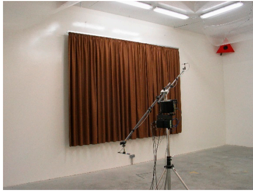
Figure 2 Détermination du coefficient d'absorption \alpha_s du bruit sous incidence diffuse en salle réverbérante selon la norme NBN EN ISO 354.
