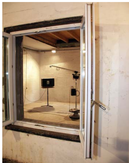
Fig. 1 Il existe désormais des châssis à double ouvrant dont l'indice d'affaiblissement est de l'ordre de 45 dB.
