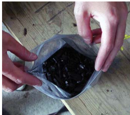
Bois contaminé transformé en charbon de bois propre après thermolyse.
