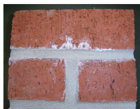
Application de l'essai sur la brique rouge avec apparition d'efflorescences (voile et cristaux téneus).
