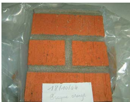
Application de l'essai sur la brique orange sans apparition d'efflorescences.
