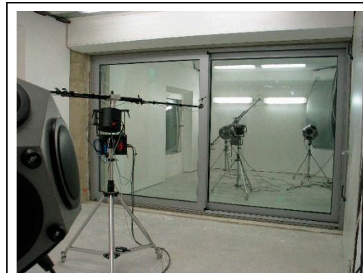
Fig. 1 Détermination de l'indice d'affaiblissement acoustique R en laboratoire selon NBN EN ISO 10140-2.
