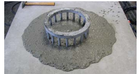
Festlegung der Fließgeschwindigkeit mit Hilfe eines J-Ringes.
